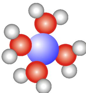
Versuch: Wassermoleküle sind so polar, dass sie von einer elektrisch aufgeladenen Plastikfolie angezogen werden. Dass Wasser ein gutes Lösungsmittel für Salze ist, hat genau den selben Grund: Ionen ziehen Wassermoleküle an (Beispiel: Salz, das im Streuer durch Feuchtigkeit klumpt) und Wassermoleküle finden Kationen und Anionen gleich attraktiv. In den nebenstehenden Abbildungen sind Wassermoleküle links als Ellipsen (nach der Art der Physiker) gezeichnet, es geht aber auch anders (rechts).
